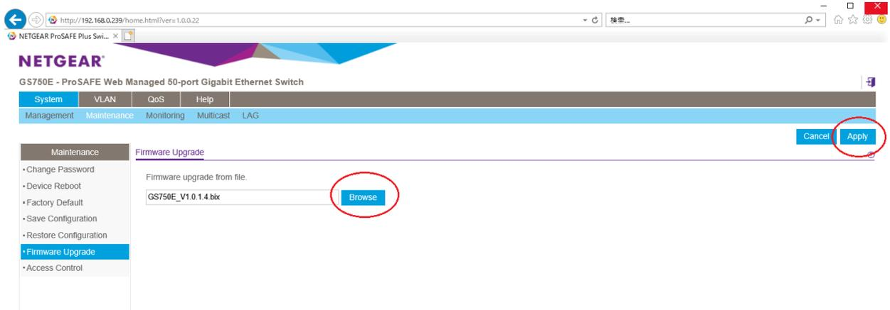
7. アップデートが開始され、その後スイッチは自動的に再起動します。アップデートが完了するまで約 2,3 分お待ちください。
